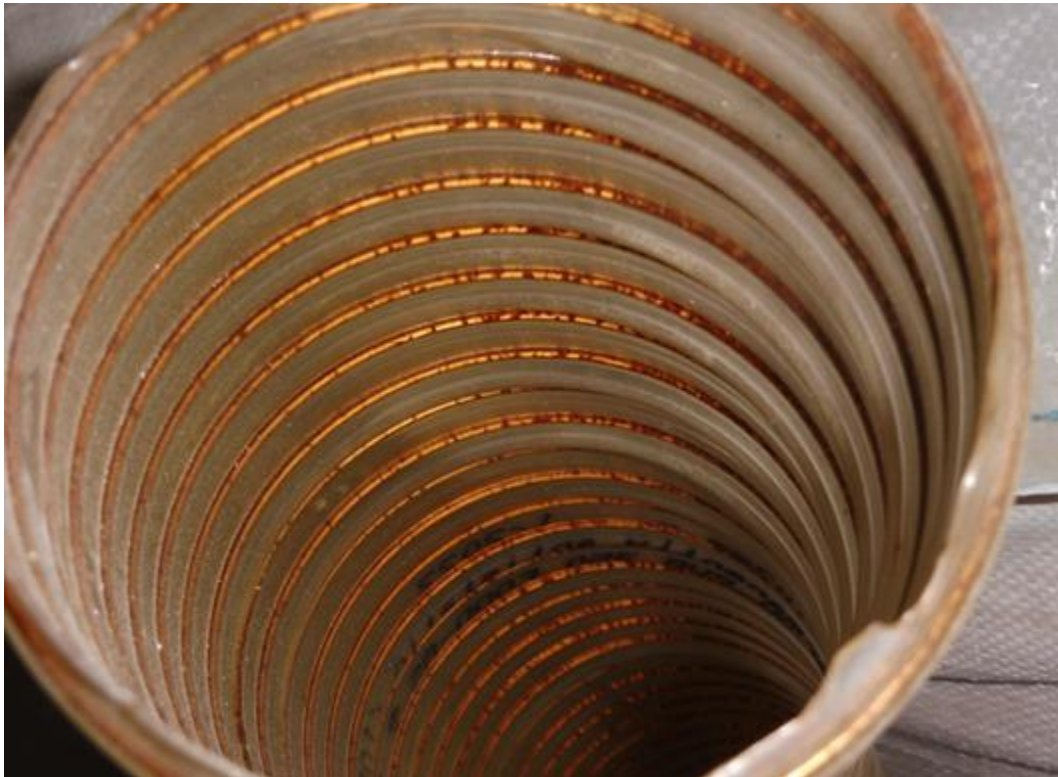
Fot. II.30. Przewody transportujące mikrogranulat
